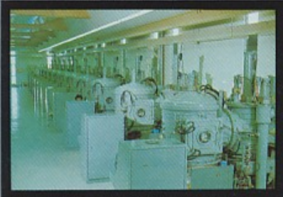
Vakuum-Vergütungsanlage für Verbesserung der SMC Technologie.
